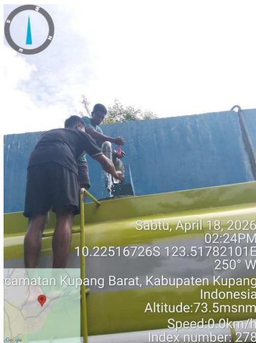
Pengambilan Sampel Air Bersih Untuk Pemeriksaan Parameter Bau, Warna, Rasa
