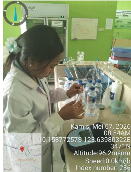
Pemeriksaan Kekeruhan Air Bersih Menggunakan Alat Turbidimeter
