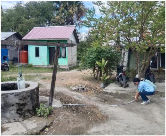
Pengukuran jarak sumur ke cubluk/resapan
