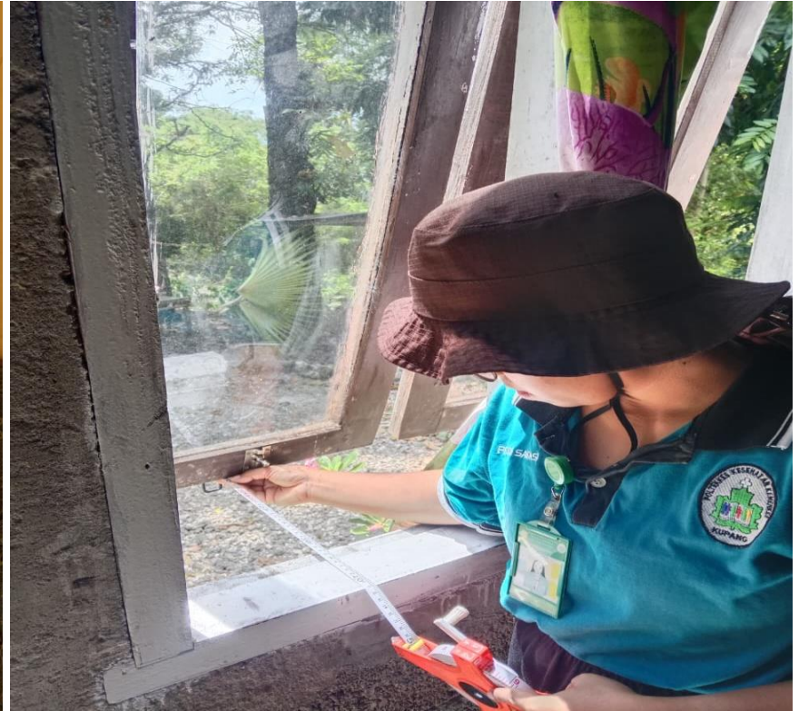
Melakukan pengukuran bukaan jendela
