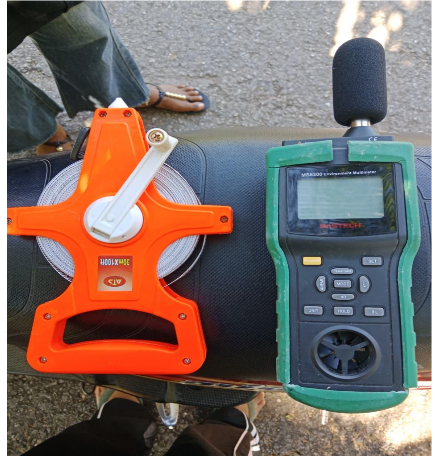
Alat yang digunakan untuk melakukan pengukuran luas ventilasi, suhu, kelembapan dan pencahayaan
