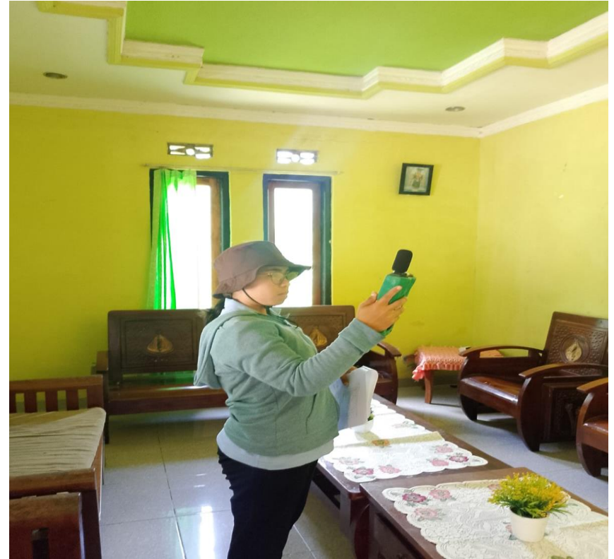
Melakukan pengukuran suhu, kelembaban dan pencahayaan
