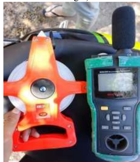
Alat yang digunakan yaitu roll meter dan alat ukur kualitas udara multifungsi
