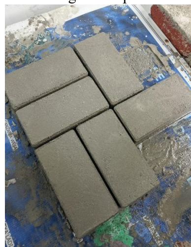
Pencetakan dan pengeringan Paving Block
