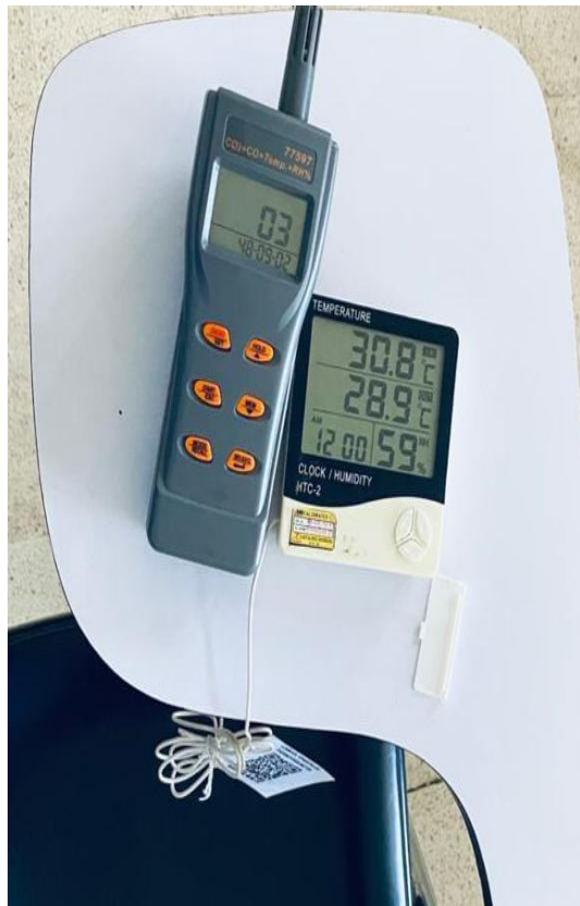
Alat pengukuran CO 2 , suhu dan kelembapan pada ruangan kelas Prodi Sanitasi dan Keperawatan
