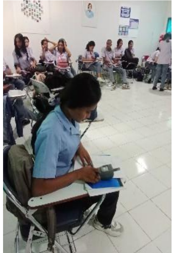
Pengukuran suhu, kelembapan dan CO 2 pada ruangan kelas Jurusan Keperawatan Poltekkes Kemenkes Kupang
