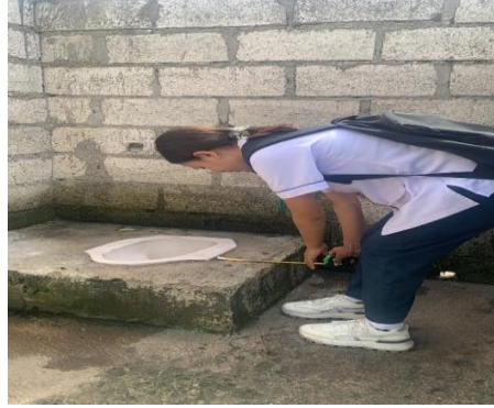
Mengukur luas slab pada jamban
