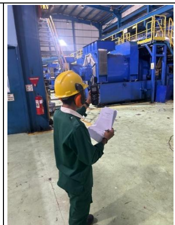
Gambar 6 Pengukuran kebisingan di ruangan operator mesin
