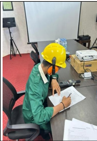
Gambar 2 Pengukuran kebisingan di ruangan meeting room
