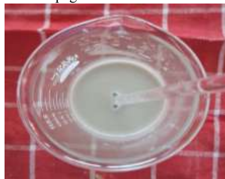
Gambar 20. Pembuatan bentonit magma
