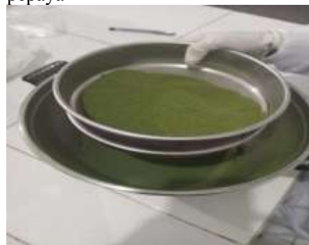
Gambar 6. Penyaringan menggunakan mesh 60
