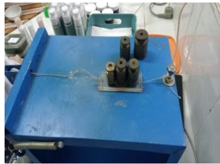
Gambar 3. Pengujian Daya Lekat
