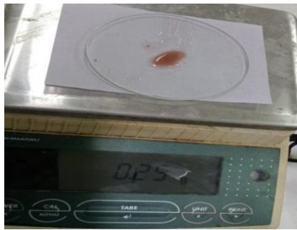
Gambar 3. Pengujian Daya Lekat
