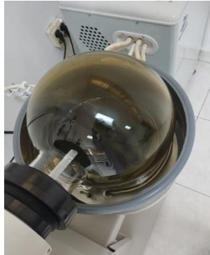
Gambar 17. Hasil maserasi di evaporasi menggunakan suhu 60 derajat selama 8 jam
