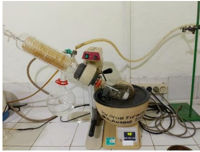
Proses pemekatan ekstrak menggunakan evaporator
