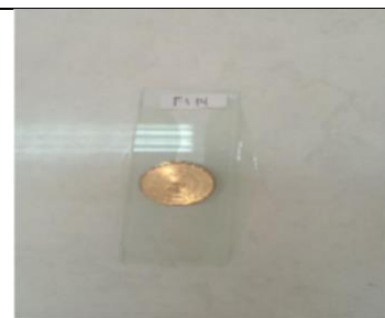
Gambar 22. Sampel ditutup menggunakan glass objek B dan diberi beban 50 g
