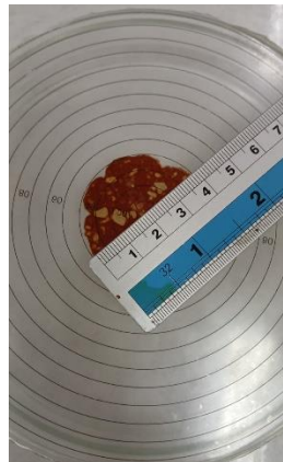
Uji daya sebar
