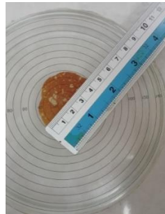
Uji daya sebar
