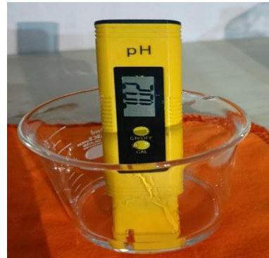
Gambar 11. Pengukuran pH parafin cair (7.02)
