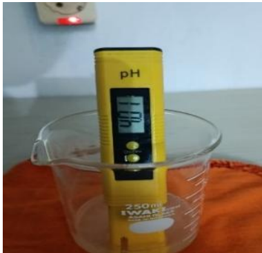
Gambar 10. Pengukuran pH gel daging lidah buaya (4.01)
