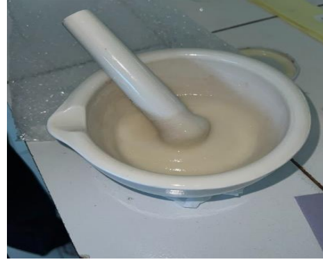
Gambar 23. Proses pencampuran fase minyak dan fase air
