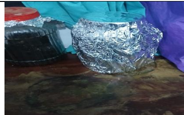
Gambar 10. Setelah diserkai ampas diremaserasi dengan alkohol 95 % sebanyak 500 mL. Ditutup dengan aluminium foil dan dibiarkan selama 2 hari
