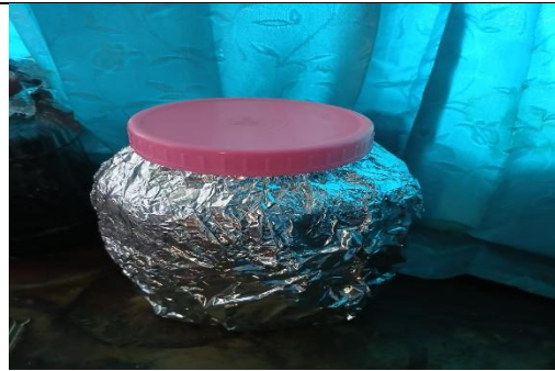
Gambar 8. . Serbuk simplisia dimasukkan ke dalam bejana/toples kaca, ditambahkan etanol 95 % 1,500 mL ditutup dengan aluminium foil dan dibiarkan selama 3 hari
