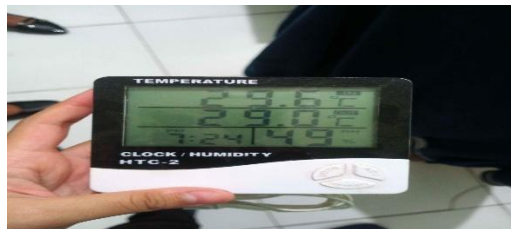
Gambar 16.3 Terdapat alat pemantau suhu ruangan berupa HTC-2 namun tidak ada label kalibrasi
