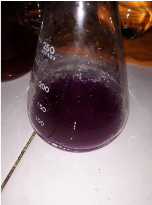
Gambar perubahan warna sebelum dan sesudah titrasi penentuan kadar kalsium dalam 100 mg kalsium oksalat
