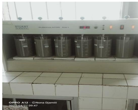
Keterangan : Proses Pengadukan Cepat 100 Rpm 1 Menit, Lambat 20 Rpm 15 Menit Di Flokulator
