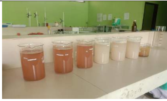
Gambar 6. Pencampuran dosis yaitu 4 gram/1 L air
