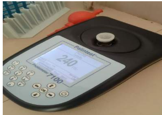
Gambar 9. Pengukuran kadar kekeruhan sebelum perlakuan
