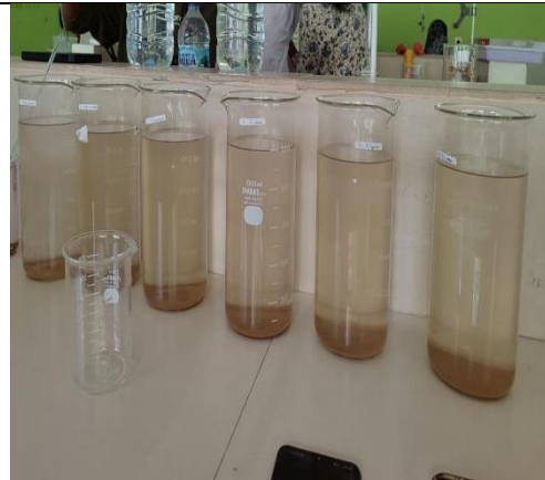
Sampel air sumur gali setelah ditambahkan koagulan bubuk biji faloak dan dilakukan pengadukan cepat, pengadukan lambat dan sedimentasi
