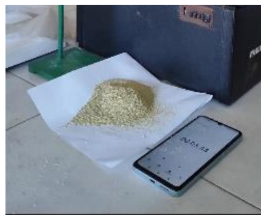
Gambar 24. Evaluasi karakteristik aliran granul
