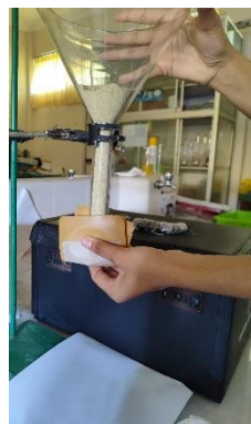
Gambar 24. Evaluasi karakteristik aliran granul
