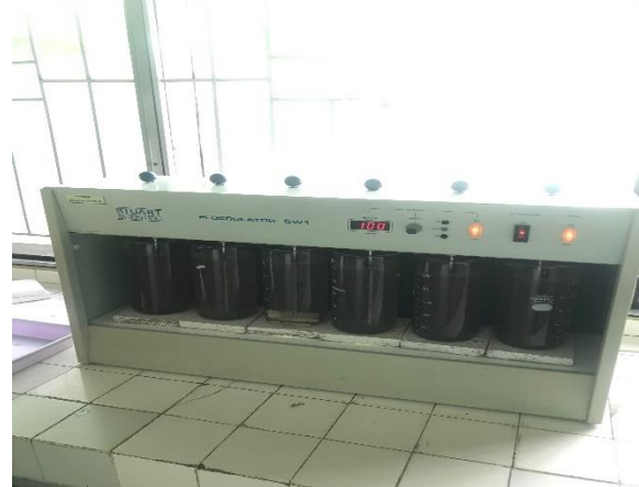
Gambar 2. Proses pengadukan cepat dan pengadukan lambat pada air sumur gali yang telah di tambahkan koagulan Serbuk kulit pisang kepok.
