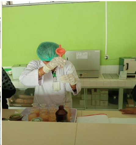
Gambar 6. sampel yang di tambahkan 1 ml larutan alkali iodida asida.
