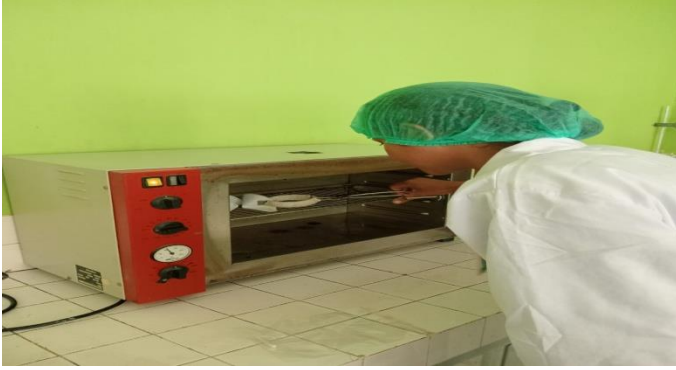
Gambar 11. Pemanasan kertas saring dengan suhu 100°C selama 120 menit atau 2 jam.
