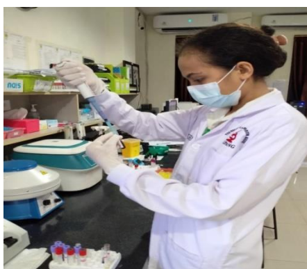
Melakukan pemipetan sampel ke dalam cup
