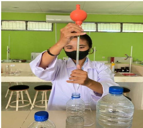
Pipet sampel kedalam tabung erlenmeyer lalu pipet larutan penyangga kedalam tabung erlenmeyer
