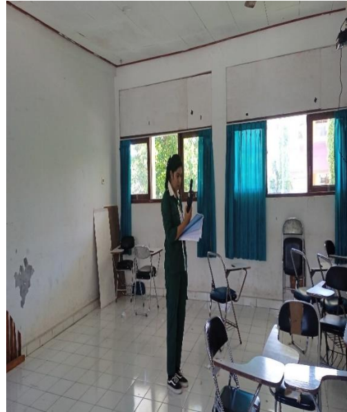
Pengukuran pencahayaan pada ruang kelas jurusan keperawatan Poltekkes Kemenkes Kupang
