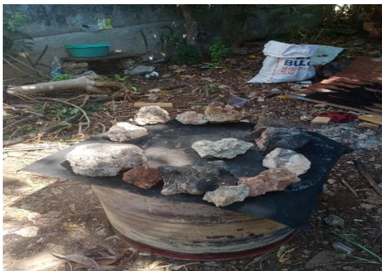
Gambar 3. Pembakaran arang dengan metode pirolisis
