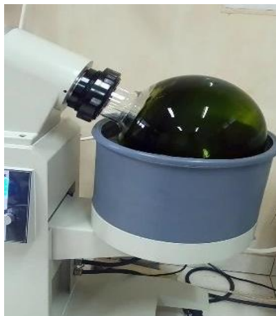
Pemekatan dengan Rotarry Evaporator
