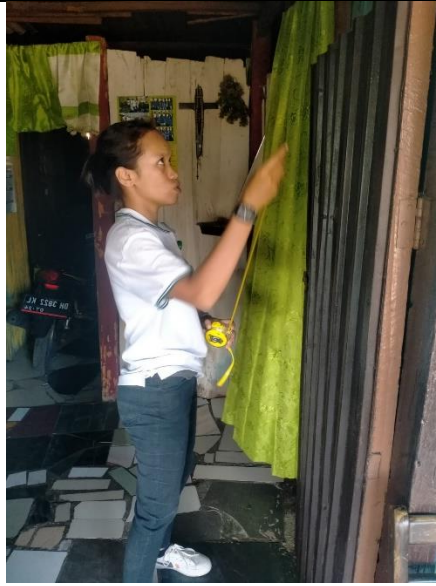
Gambar b. Pengukuran luas ventilasi
