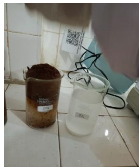
Bubuk cengkeh yang sudah ditimbangan pada masing-masing beaker glass yang sudah berisi air biasa dan air soda
