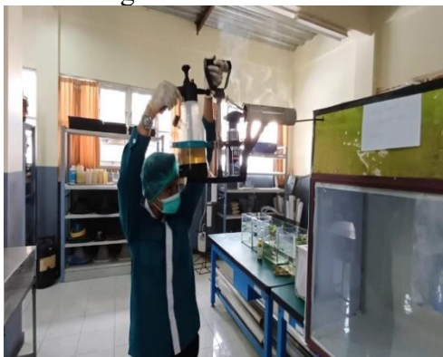
Penyemprotan asap fogging kedalam kotak uji
