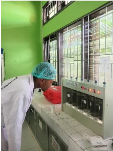
Proses flokulasi menggunakan flokulator setelah di masukan bubuk kulit pisang ke dalam baker glass
