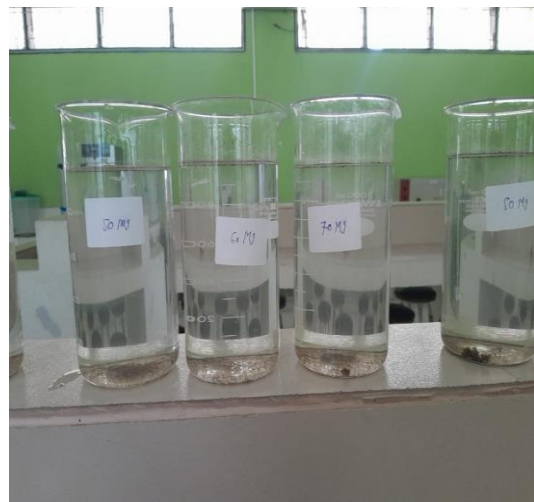
Hasil penurunan kekeruhan Sampel air yang telah di flokulasi menggunakan flokulator
