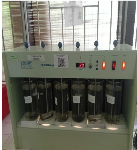
Proses flokulasi menggunakan flokulator setelah di masukan bubuk kulit pisang ke dalam baker glass
