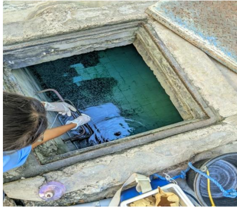
Pengambilan Sampel Air Pada Reservoir Asrama Sanitasi Umtuk Pemeriksaan Bakteriologis
