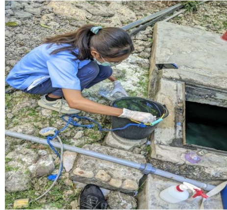
Pengambilan Sampel Air Pada Reservoir Asrama Sanitasi Umtuk Pemeriksaan Kimia
