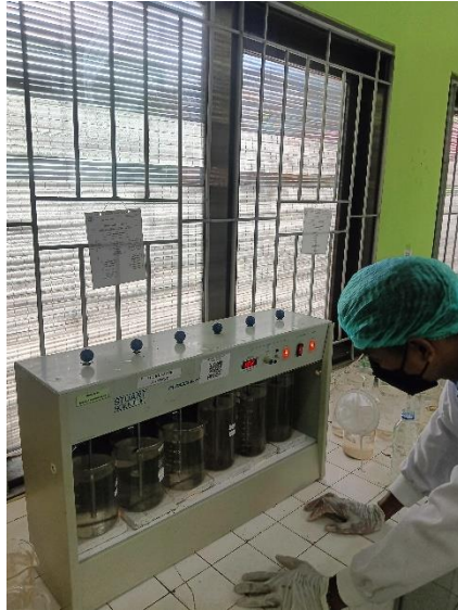
Proses pengadukan sampel menggunakan flokulator
