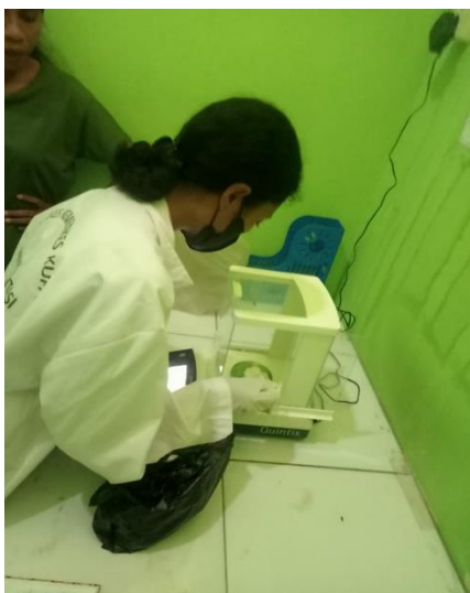
Penimbangan kaporit pada Timbangan
