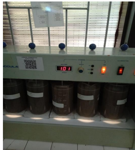
Gambar 4. Proses pengadukan lambat pada air limbah yang telah di tambahkan serbuk biji semangka
