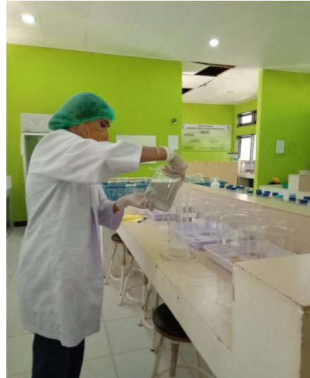
Gambar 2. Tuangkan air limbah sebanyak 1 liter air kedalam beaker glass 1000 ml
