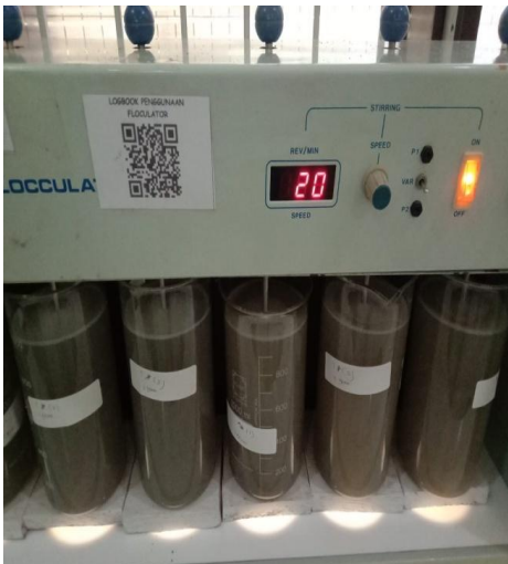
Gambar 3. Proses Pengadukan cepat pada air limbah laundry yang telah di tambahkan serbuk biji semangka
