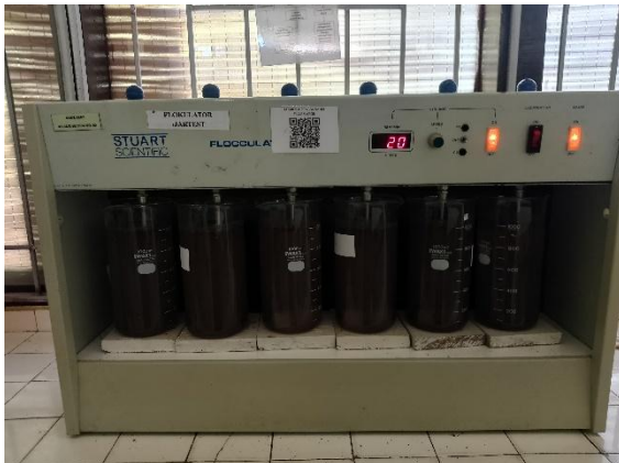
Gambar 3. Proses pengadukan cepat pada air sumur bor yang telah di tambahkan koagulan serbuk biji pepaya
