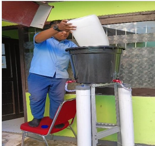
Memasukan sampel air kedalam alat penyaring
