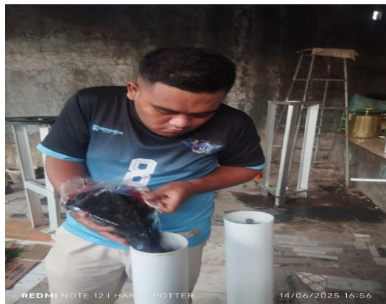
Memasukan media kedalam tabung penyaring
