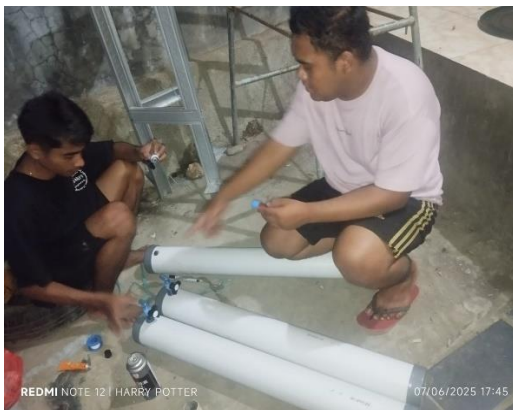
Proses pemasangan kran air pada tabung penyaring
