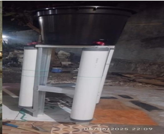
Proses perakitan penyagga dan tabung penyaring
