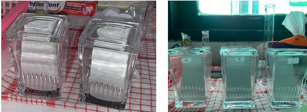
Gambar 12. Penjenuhan Fase Gerak dan Proses Elusi
