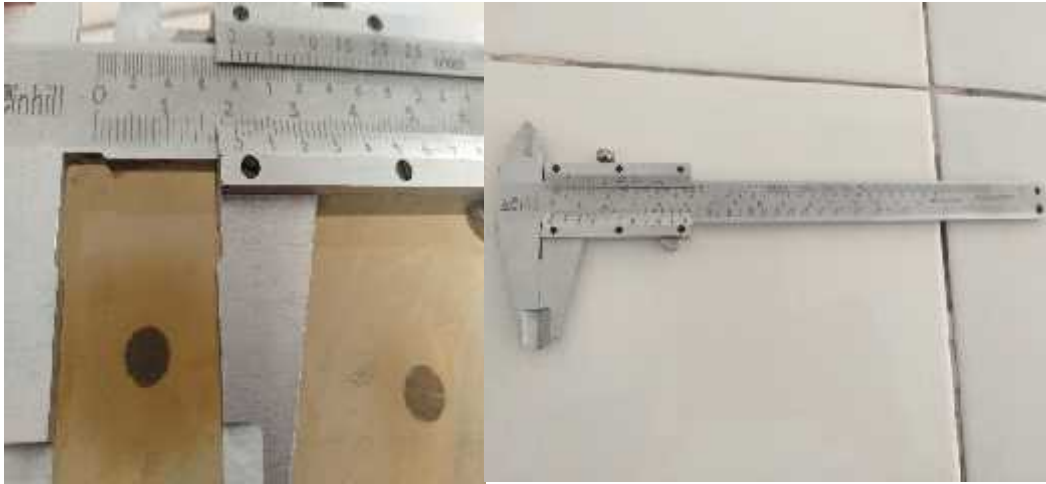
Gambar 14. Pengukuran Zona Hambat yang terbentuk pada media uji dengan jangka sorong
