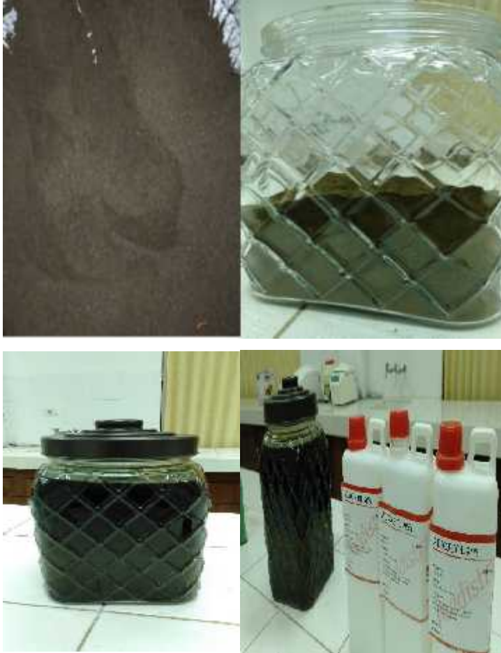
Gambar 2. Proses Maserasi Daun Sirih Hijau dengan Etanol 96%
