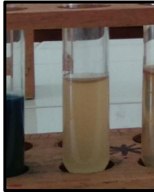
Gambar 5. Hasil Uji Indol Negatif (-) sampel bakteri uji. (Sumber: Data primer penelitian 2019)
