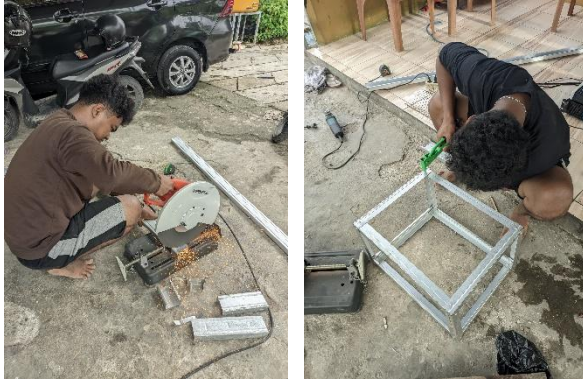
1. Pemotongan besi aluminium dan perakitan rangka alat
