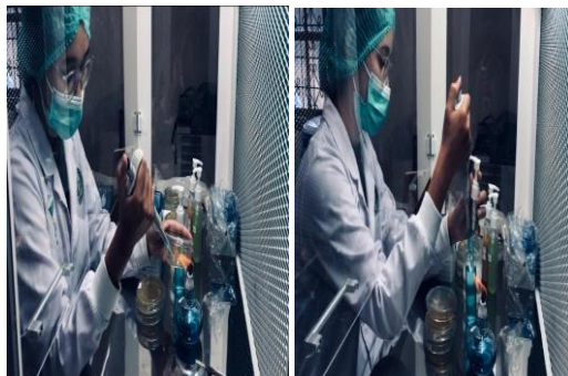
Gambar 45. Sampel sabun ditetaskan ke dalam sumuran
