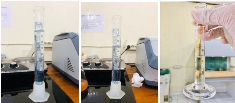
Gambar 35. Pengukuran Aquades sebagai pelarut media
