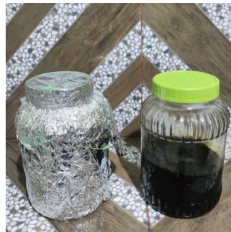
Gambar 11. Setelah diserkai ampas diremaserasi dengan alkohol 70 % sebanyak 500 mL. Ditutup dengan aluminium foil dan dibiarkan selama 2 hari
