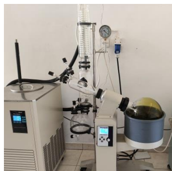
Gambar 12. Hasil maserasi dan remaserasi diuapkan di rotary evaporator
