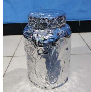
Gambar 9. Serbuk simplisia dimasukkan ke dalam bejana/toples kaca, ditambahkan etanol 70 % 1,500 mL ditutup dengan aluminium foil dan dibiarkan selama 3 hari.
